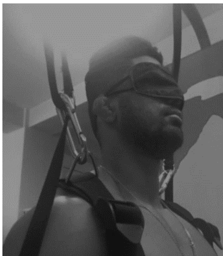
شکل ۳: نحوه استفاده از چشم بند و جلیقه ایمنی حین اجرای آزمون
