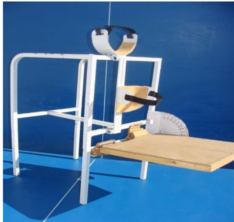
شکل ۱-۱ گونیامتر پدال دار (حرکات Plantarflexion و Dorsiflexion)
