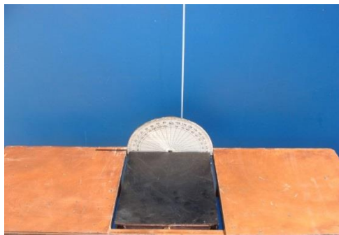
شکل ۱-۲ گونیامتر پدال دار (حرکات Inversion, Eversion)
