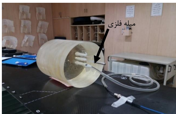
شکل ۴: قرار گیری فارمر و میله فلزی در فانتوم به منظور اندازه‌گیری دوز رسیده به مرکز فانتوم
