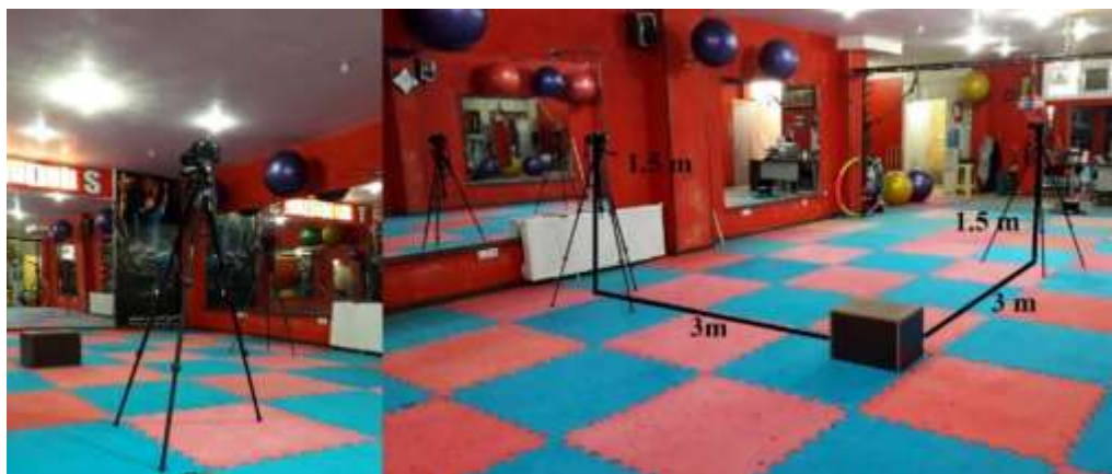
تصویر ۱: نمایی از نحوه چیدمان تست در فرود تک پا و دوپا
