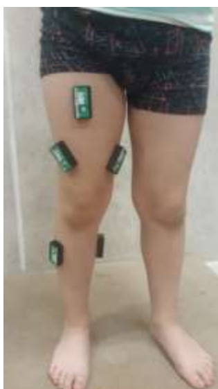
شکل ۱: نحوه قرار گیری الکترودها
